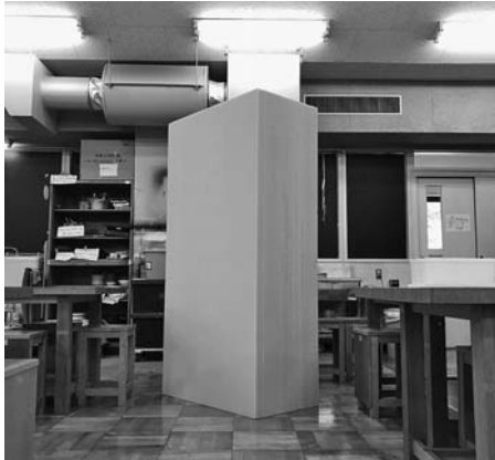
【写真 3】 複数枚を積層し、木工用ボンドで 圧着したスタイロフォーム
