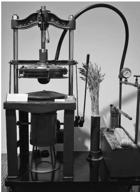
写真10 麦わら帽子製作水圧機の全体像 (出所：ブラザーコミュニケーションスペース)
